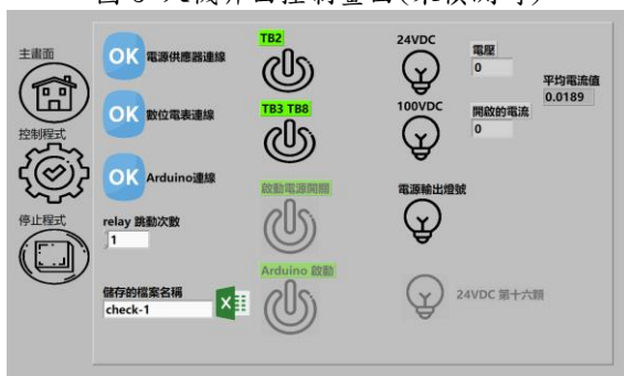
圖 4 人機介面控制畫面(偵測時)
