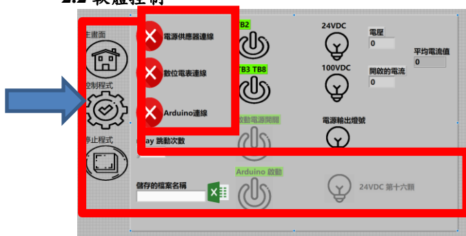
圖 3 人機介面控制畫面(未偵測時)
